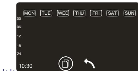
Für jeden Wochentag können bis zu 4 Betriebszeiten eingestellt werden. Den Bereich des Displays drücken, der dem Tag entspricht, welcher konfiguriert werden soll, dann die Programmierung der Uhrzeiten vornehmen.
