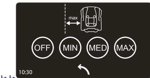
Stellen Sie den Abstand des Roboters zum Umzäunungsdraht während der Rückkehr zur Ladestation ein.
