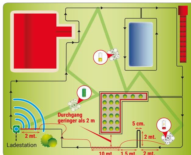
Falls enge Durchgänge vorhanden sind, muss der Draht in einer besonderen Form verlegt werden, dem so genannten „Rückruf am Draht“.
