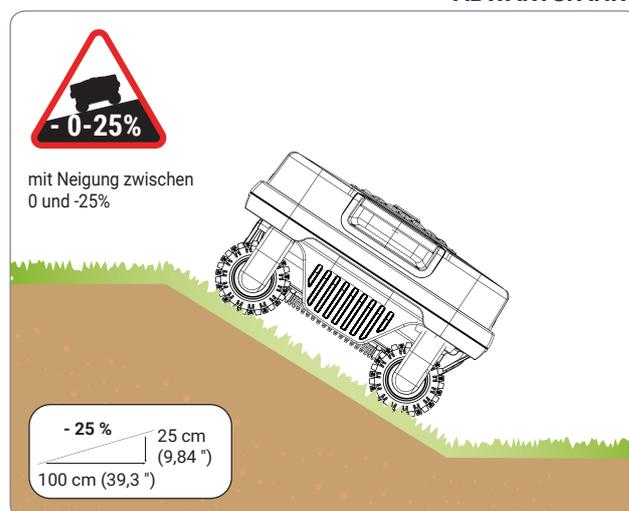
Der Roboter kann Niveauunterschiede mit einer Neigung bis 25% bewältigen, falls sie plötzlich auftreten.
