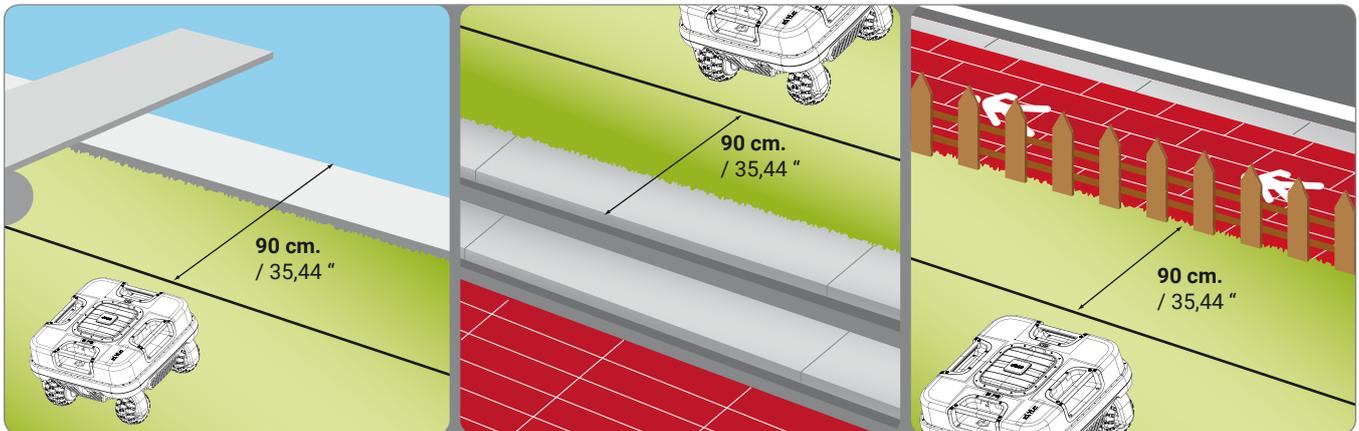
Der Roboter ist mit Sensoren ausgestattet, die in Bewegung befindliche Hindernisse erfassen können. Für einen sicheren und leisen Betrieb raten wir an, jedes feststehende Hindernis jeder Form und Größe zu umzäunen.
