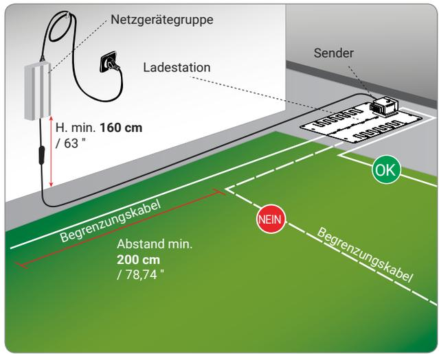
Falls der Roboter in der Nähe eines Bereichs installiert wird, in dem schon ein anderer Roboter installiert ist (des gleichen oder eines anderen Herstellers) müssen bei der Installation der Sender und Empfänger des Roboters so modifiziert werden, dass die Frequenzen der beiden Roboter einander nicht gegenseitig stören. Setzen Sie sich in diesem Fall mit dem nächstgelegenen Kundendienstzentrum in Verbindung.
