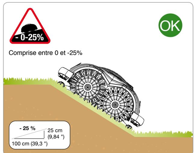
Le robot est en mesure d'affronter des différences de niveau allant jusqu'à 25% même si elles se manifestent de manière soudaine.
