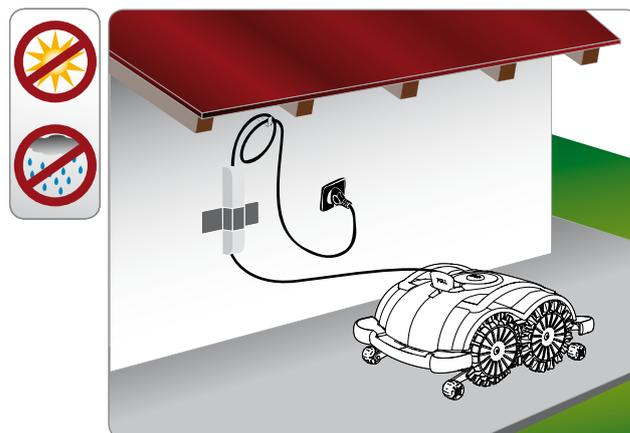
Lorsque le robot s'est arrêté pour les raisons décrites dans le chapitre "Arrêt du Robot", arrêter en sécurité et remettre le robot dans la zone d'alimentation pour qu'il soit rechargé.
