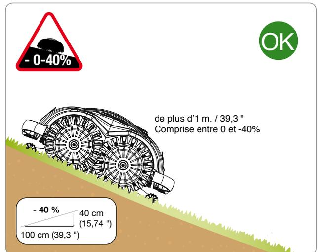
Le robot est en mesure d'affronter des différences de niveau jusqu'à 40% Pourvu qu'elles dégradent dans une distance supérieure au mètre.
