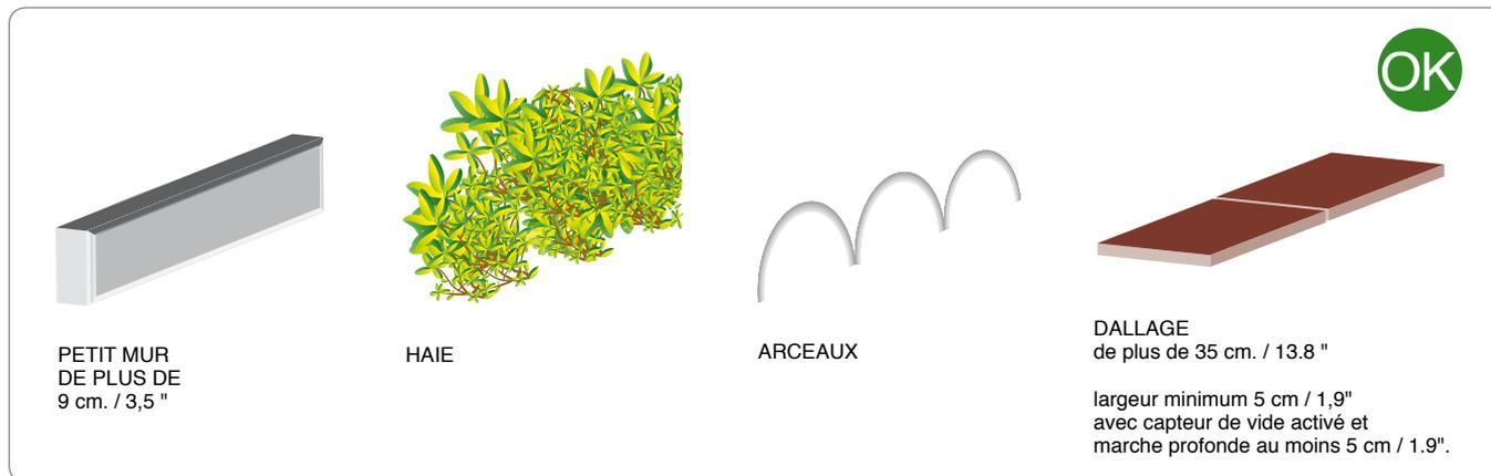
Types de délimitations/protections pouvant être utilisées pour délimiter la zone de travail du robot.
